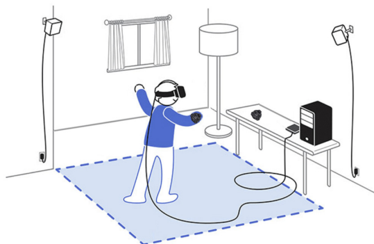
Figura 3 – Área de cobertura das Base Stations SteamVR 2.0.
