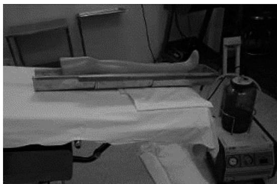
Figura 5. Protótipo modelo 2 sobre a mesa da sala cirúrgica, apoiando o membro inferior de um manequim, ligado ao frasco de aspiração de secreção.
