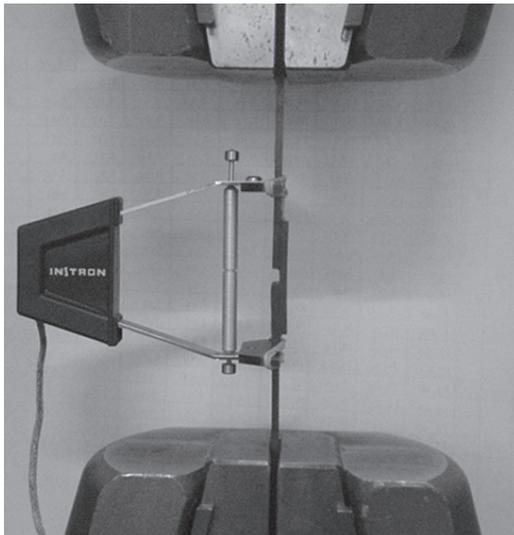
Fig. 3. Disposição da reparação na máquina de ensaio.
