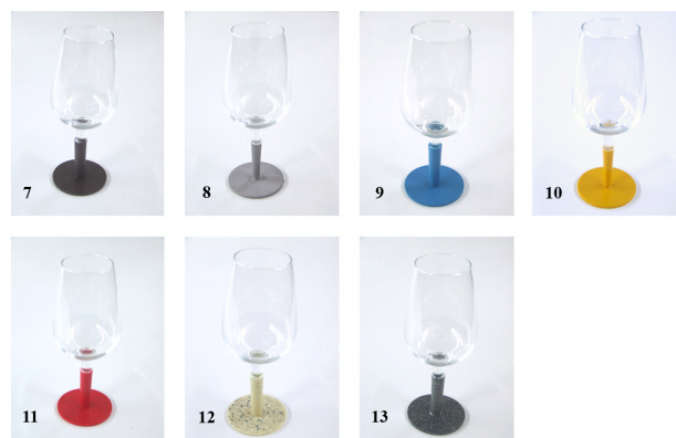
Fig. 10 - Bases dos copos obtidas por vazamento de uma mistura.
