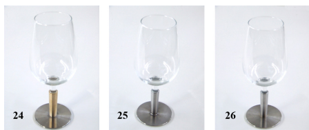
Fig. 13 - Bases dos copos obtidas por soldadura.
