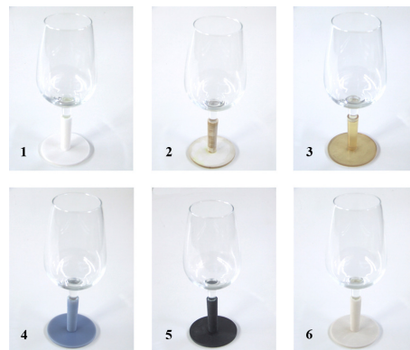
Fig. 8 - Bases dos copos obtidas por prototipagem rápida.
