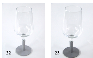
Fig. 12 - Bases dos copos obtidas por fundição de precisão.
