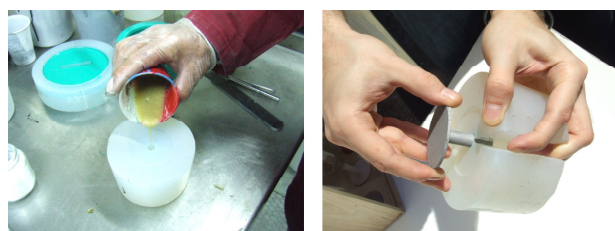
Fig. 9 - Molde em silicone para vazamento de diferentes tipos de materiais.
