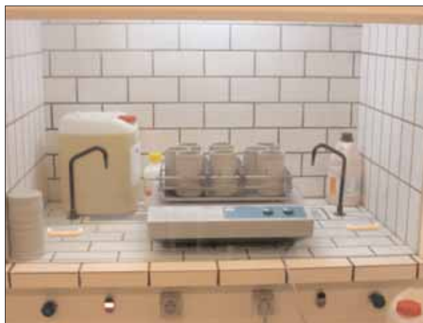
Fig. 1 – Amostras em tratamento com banho ácido em agitador orbital.
