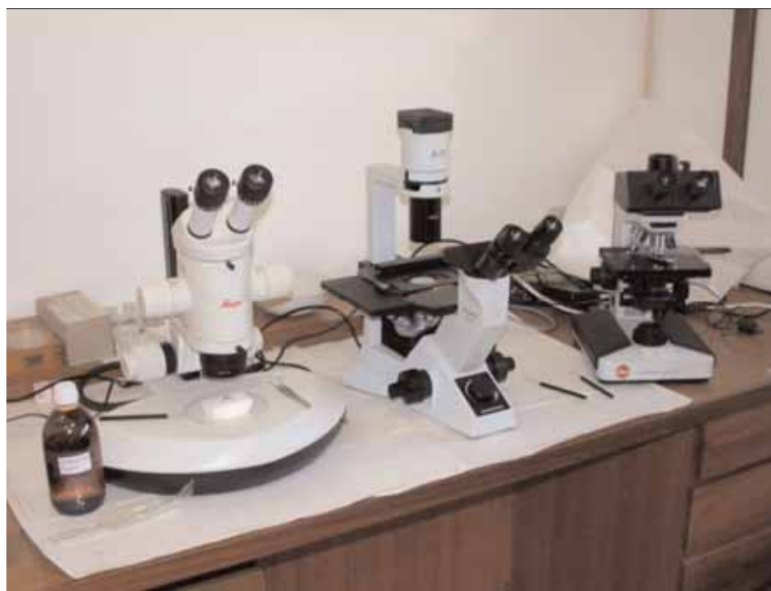
Fig. 2 – Combinação de material óptico para estudos de microscopia electrónica de varrimento. Da esquerda para a direita, lupa binocular, microscópio óptico invertido e microscópio óptico normal.
